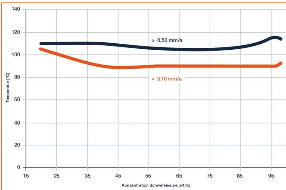
Abbildung 2 – ISO-Korrosionsdiagramm von VDM® Alloy 2120 MoN
